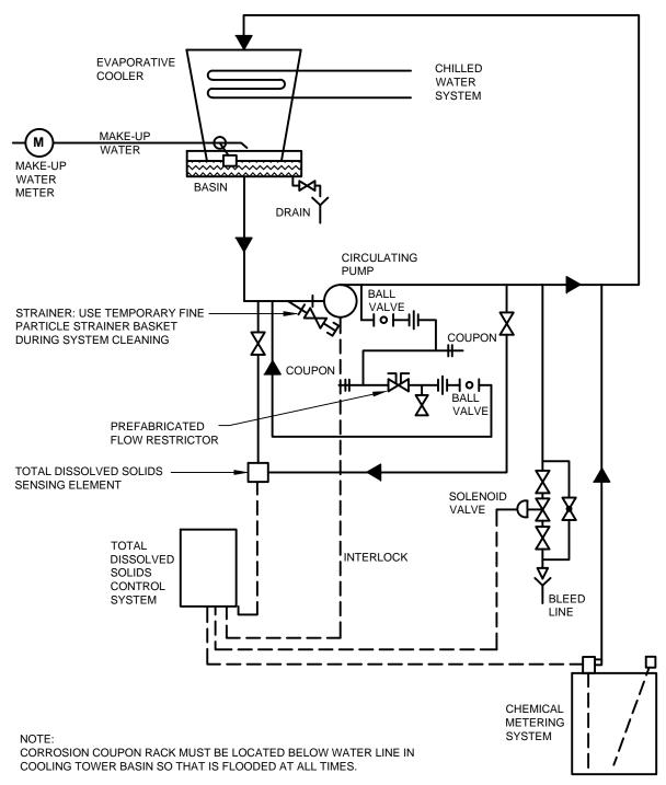
INSTALL CORROSION COUPON RACK AT OPERATING LEVEL AWAY FROM ANY ELECTRICAL EQUIPMENT.
